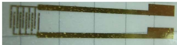
Fig 7. Senzorul impedimetric de Au pe PET obtinut prin tehnologia InkJet
