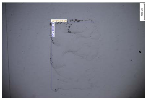
Fig 6. Test de printare pe membrana test cu QDs galben din telură de cadmiu (CdTe) funcționalizate cu grupări carboxil cu acid mercaptopropionic
